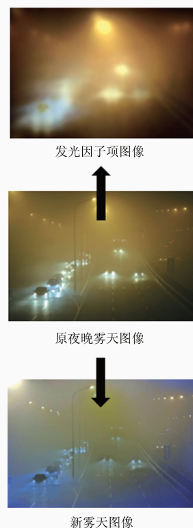
图3 利用发光因子项图像分离消除多光源影响的结果示例
